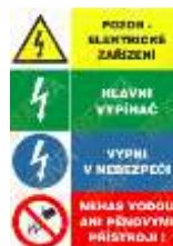
Obrázek 11 Označení staveništních rozvaděčů
