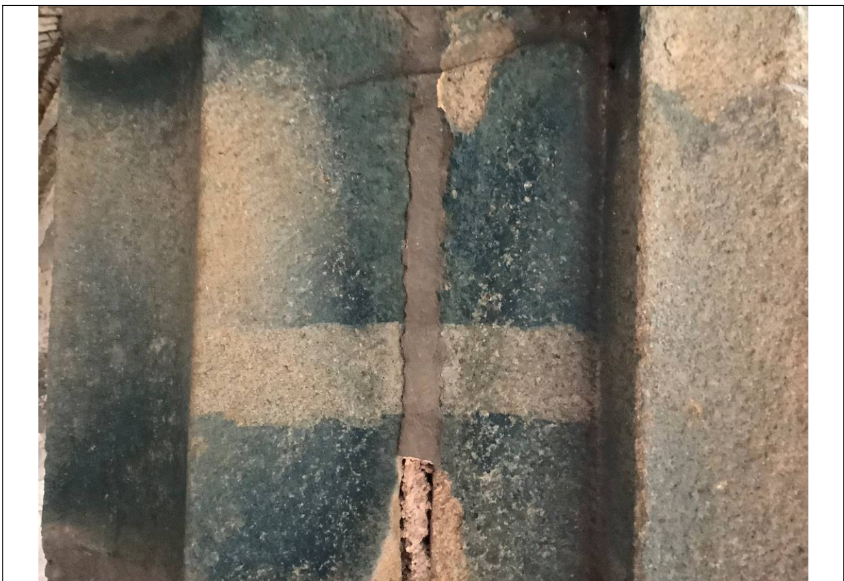
Zkouška čištění biologického povlaku na pískovci laserem. Velmi účinná a šetrná metoda.
