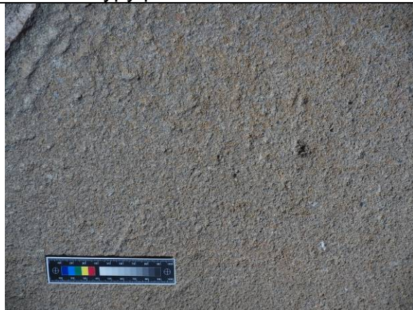
Jemně až střednězrný, pravděpodobně glaukonitický pískovec s lokálními železitými žilami.
