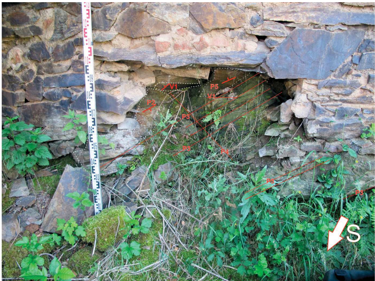
obr. 6: Přehled zjištěných diskontinuit na výchozu proterozoických břidlic.
